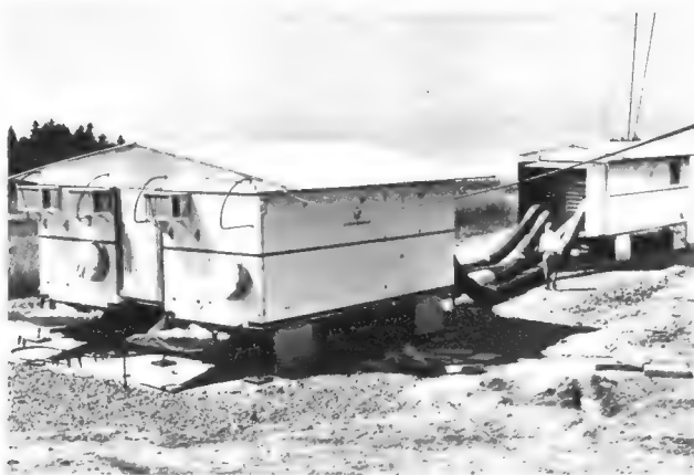
Die beiden Fahrzeuge mit dem Bild- und dem Tonsender werden nebeneinander aufgestellt. Durch Aufklappen der inneren Seitenwände und Abdichten der Vor- und Rückseite ergibt sich ein wetterfester Betriebsraum. Im Hintergrund der Lüfterwagen, der über die vier 45 cm dicken Schläuche für temperierte Umluft sorgt
